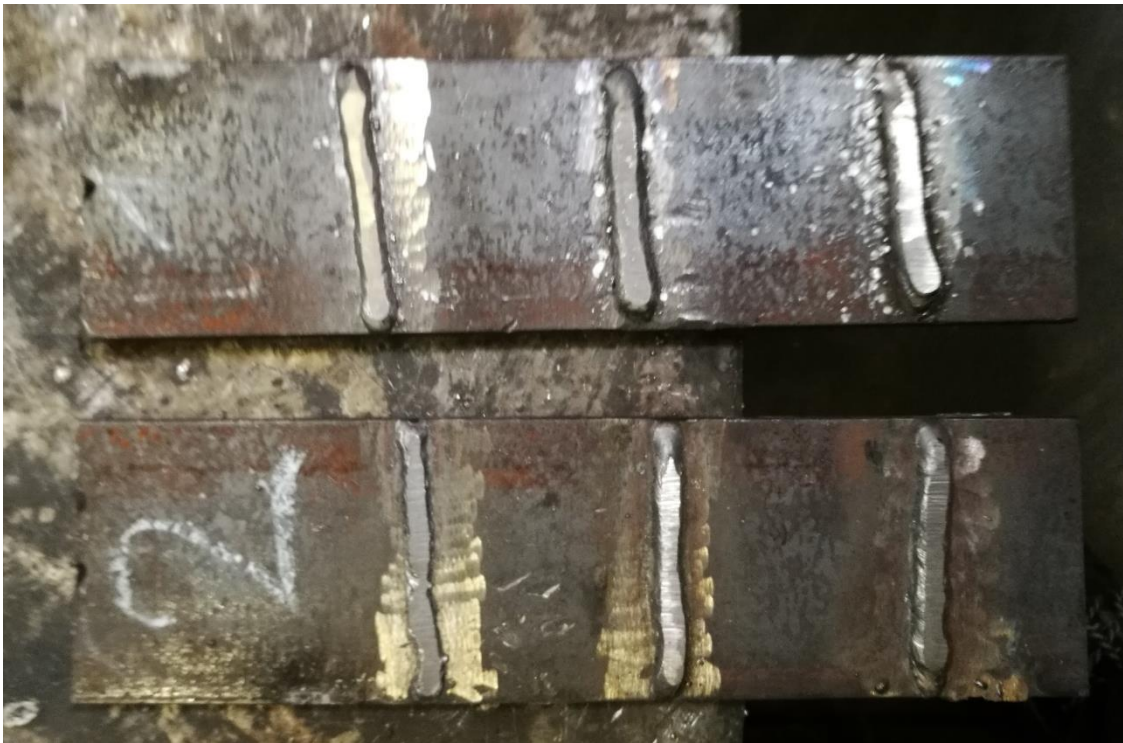
Obr. 9: Navařené vzorky; nahoře návar EnDOtec® DO*360X metodou MAG, dole návar EutecTrode®XHD6860 metodou MMA; zleva jednovrstevný, dvouvrstevný a třívrstevný.
