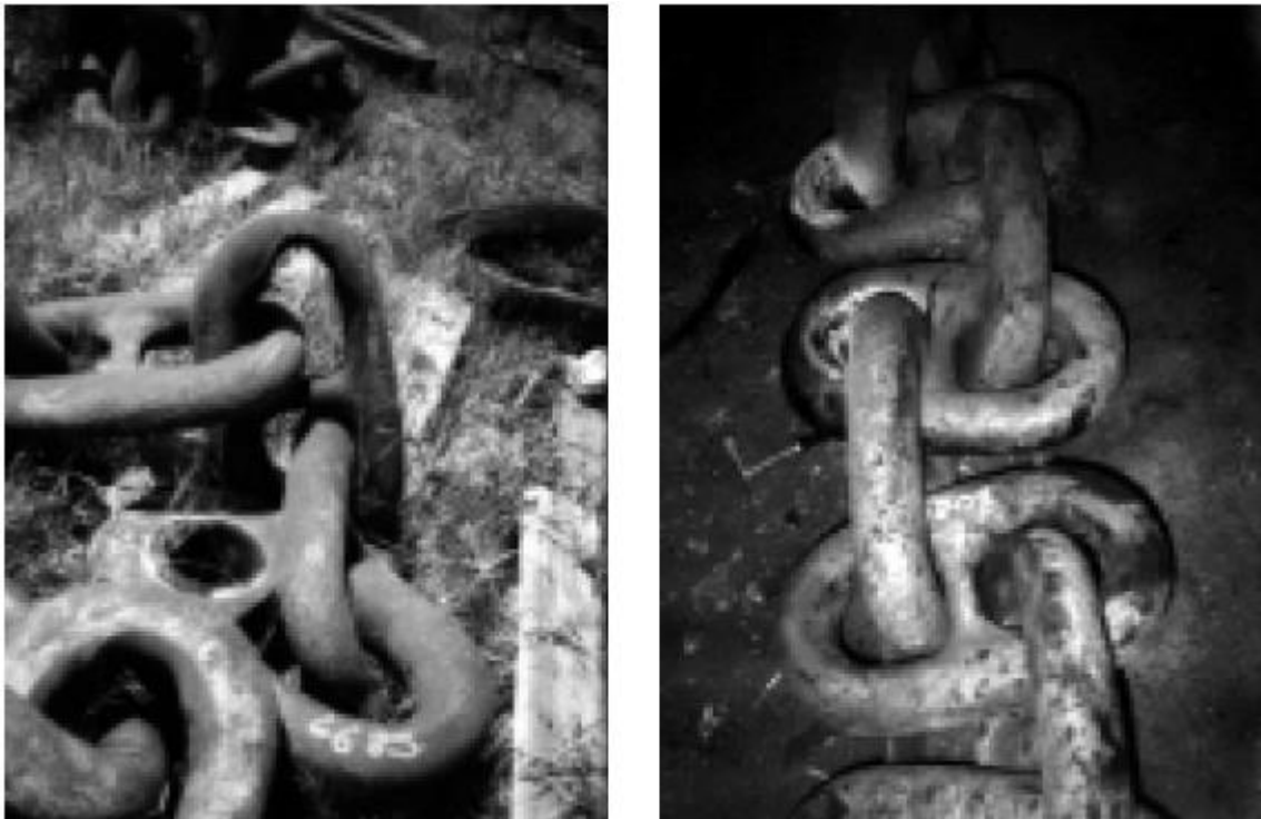
Obr. 1: Vlevo – opotřebovaný vnitřní povrch řetězu; vpravo – opravený řetěz [3]
