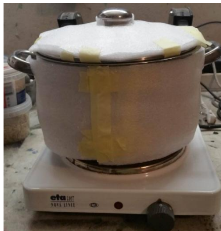
Obr. 22: Měření č. 6 - Nádoba s izolací 6 mm a s poklopem
