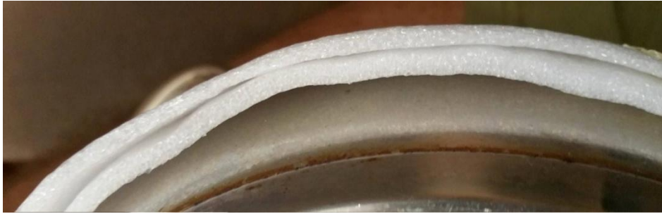
Obr. 19: Ukázka izolace 4 mm a 2 mm
