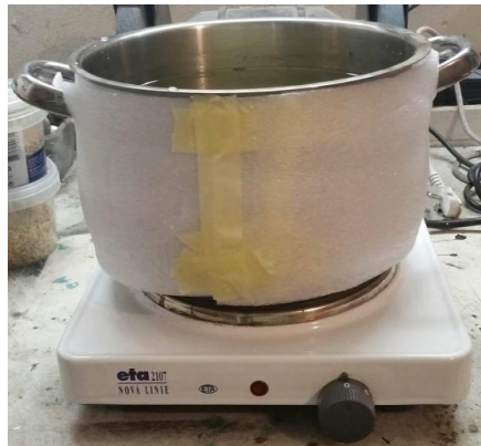
Obr. 18: Měření č. 4 - Nádoba s izolací 6 mm a bez poklopu
