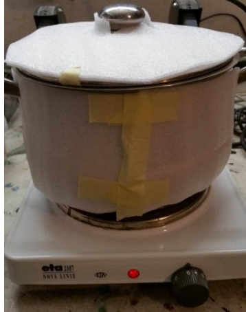
Obr. 21: Měření č. 5 - Nádoba s izolací 4 mm a poklopem
