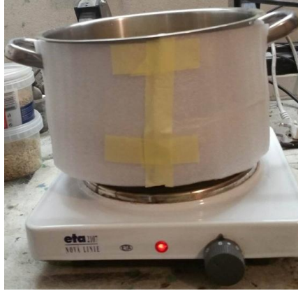
Obr. 17: Měření č. 2 - Nádoba s izolací 4 mm a bez poklopu
