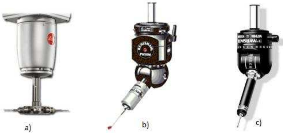
Obrázek 9: Snímací hlavice a) Pevná, b) Indexovatelná, c) Manuální [8]
