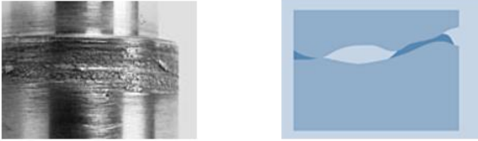
Obrázek 20: Ukázka a schmatické znázornění adhezního opotřebení [25]
