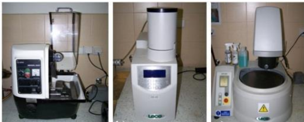
a) Bruska mikrotron 3000; b) metalografická lisovačka LECO PR – 4x; c) bruska-leštička LECO GPX 300.
