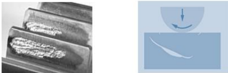
Obrázek 21: Ukázka a schmatické znázornění únavového opotřebení [25]
