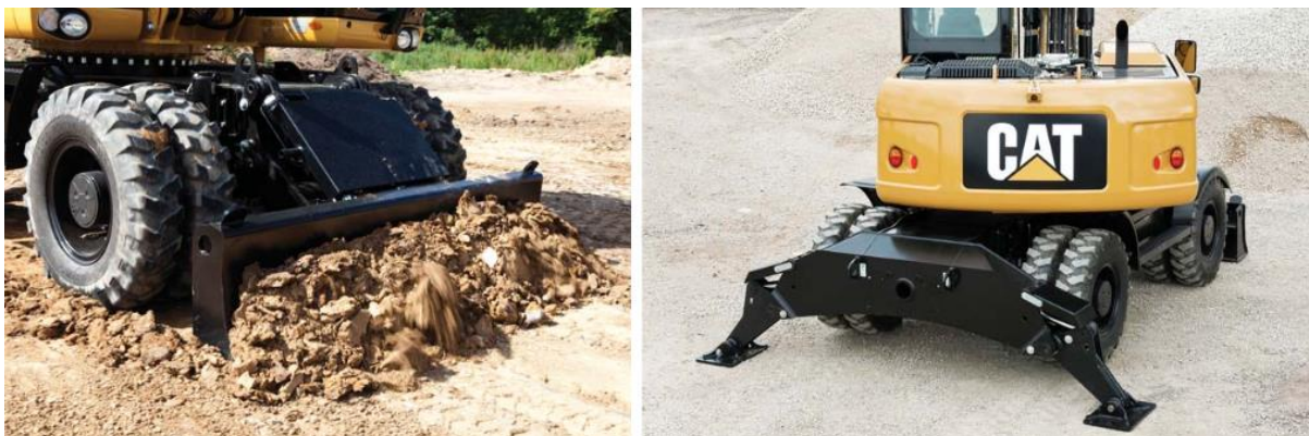
Obr. 2.: Kombinace podpěr s dozerovou radlicí [22]
