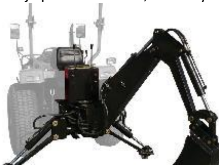
Obr. 4.: Podkop nesený za traktorem [3]
