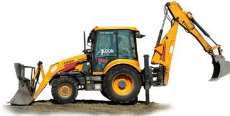
Obr. 3.: Rypadlo na traktorovém podvozku [2]
