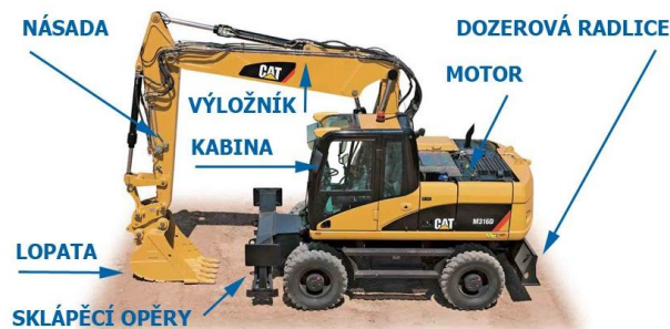
Obr. 9.: Části kolového bagru [9]
