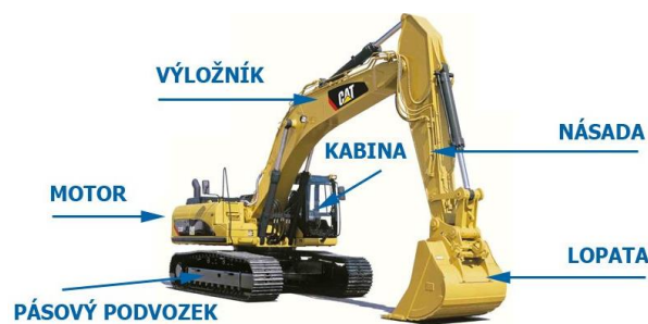
Obr. 8.: Části pásového bagru [9]
