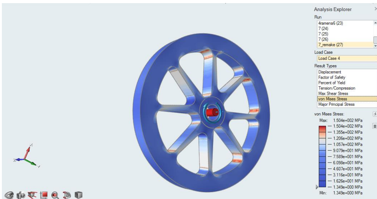
Obrázek 29, Napětí v rotoru č.8 při 25000 RPM
