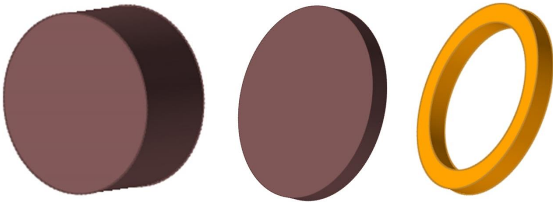
Obrázek 10. Návrhy rotoru setrvačnickové baterie (zleva plný válec, plný tenkostěnný válec, dutý tenkostěnný válec)
