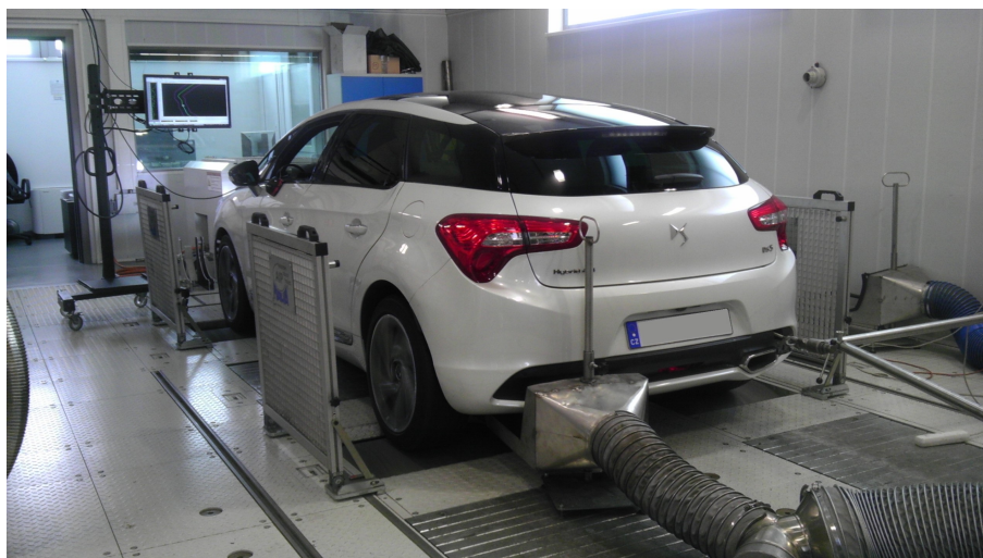
Obrázek 5.2: Vozidlo v průběhu testování na válcové brzdě
