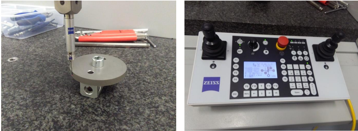
Obrázek 47: Měření na souřadnicovém měřicím stroji (vlevo), ovládací panel souřadnicového měřícího stroje (vpravo)
