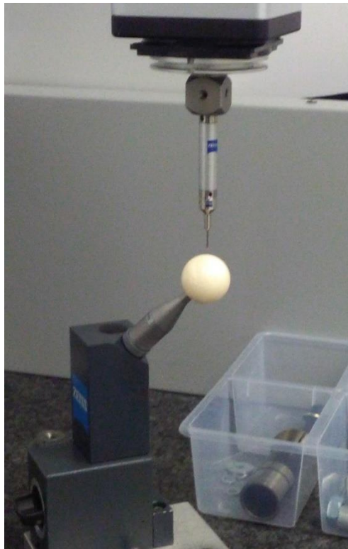
Obrázek 46: Kalibrační koule a kalibrovaný měřící senzor
