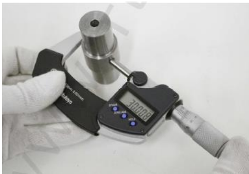
Obrázek 30: Měření kruhovitosti dvojbodovou metodou [18]
