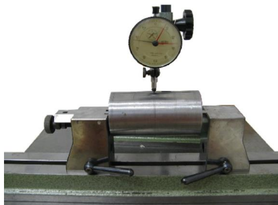
Obrázek 32: Měření kruhovitosti mezi hroty[18]
