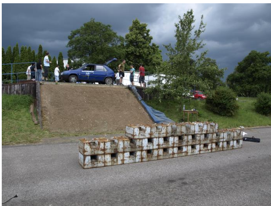
Obrázek 23: Zkušební svah a počáteční poloha vozidla [24]
