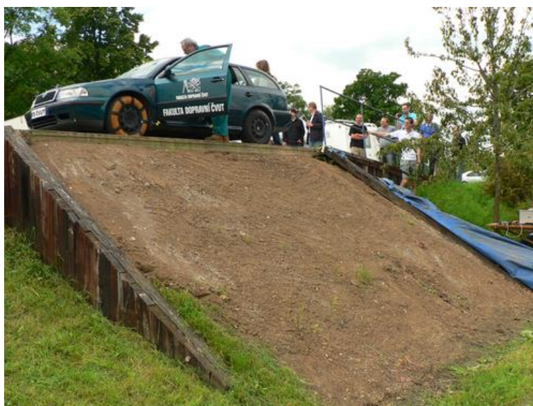
Obrázek 19: Zkušební svah a počáteční poloha vozidla [23]
