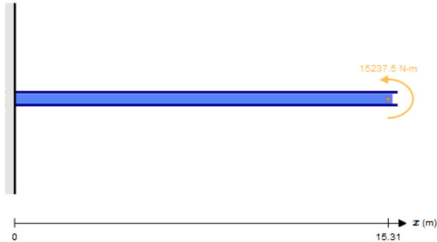
Obrázek 33 - Výpočtový model v rovině B - vetknutý nosník s osamělým momentem na konci
