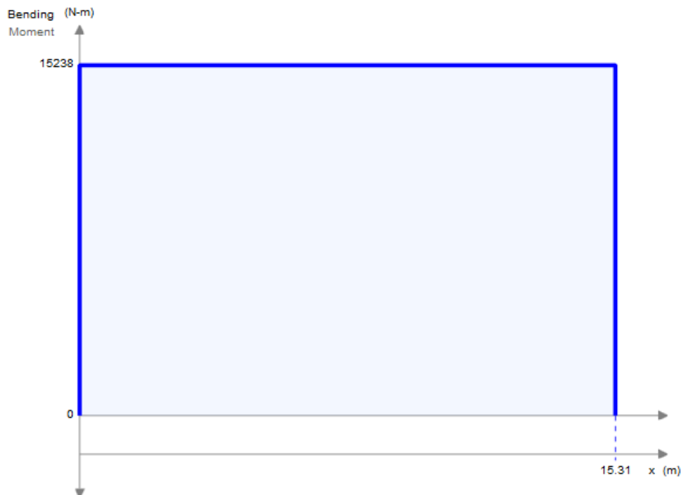
Obrázek 34 - Průběh ohybového momentu na nosníku v rovině B
