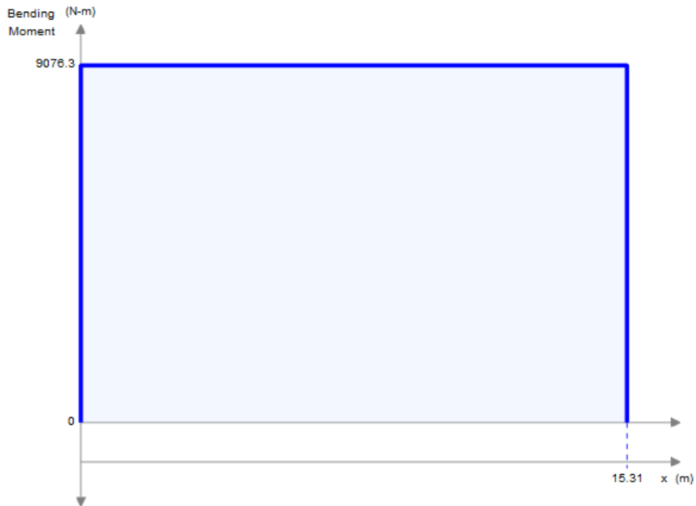
Obrázek 31 - Výpočtový model v rovině A - vetknutý nosník s osamělým momentem na konci
