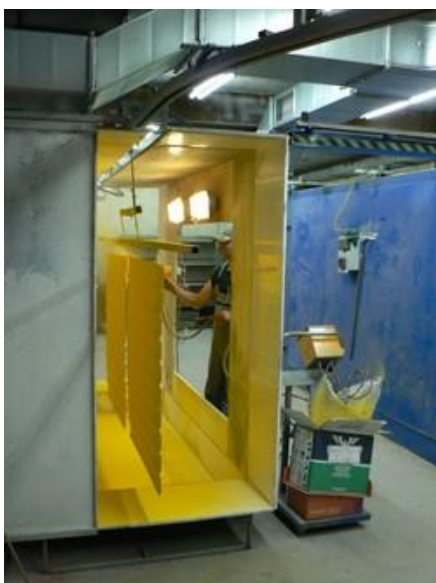
Obr. 2.29.: Nanášení práškové barvy [19]
