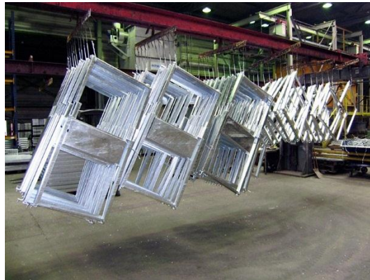
Obr. 2.28.: Povrch po žárové zinkování. [18]
