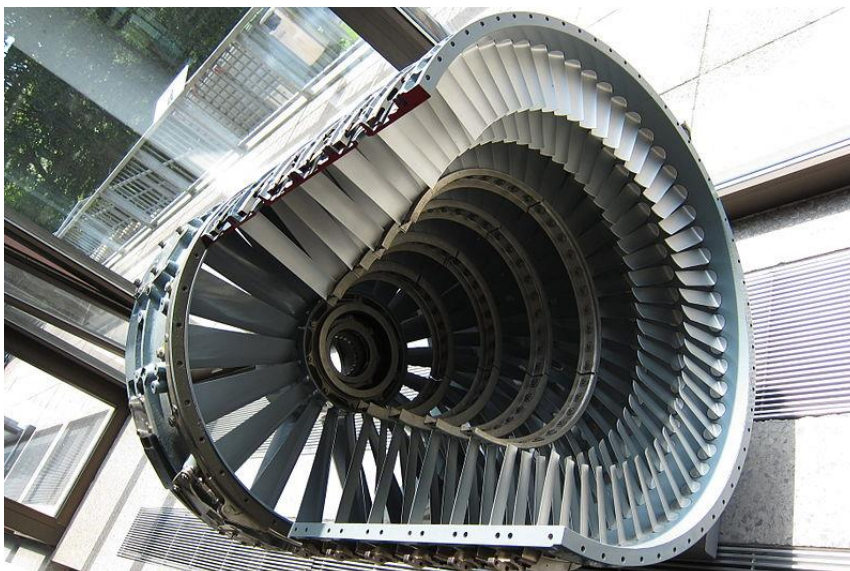
Obrázek 3 Skříň statoru axiálního kompresoru s lopatkami ( [6] )
