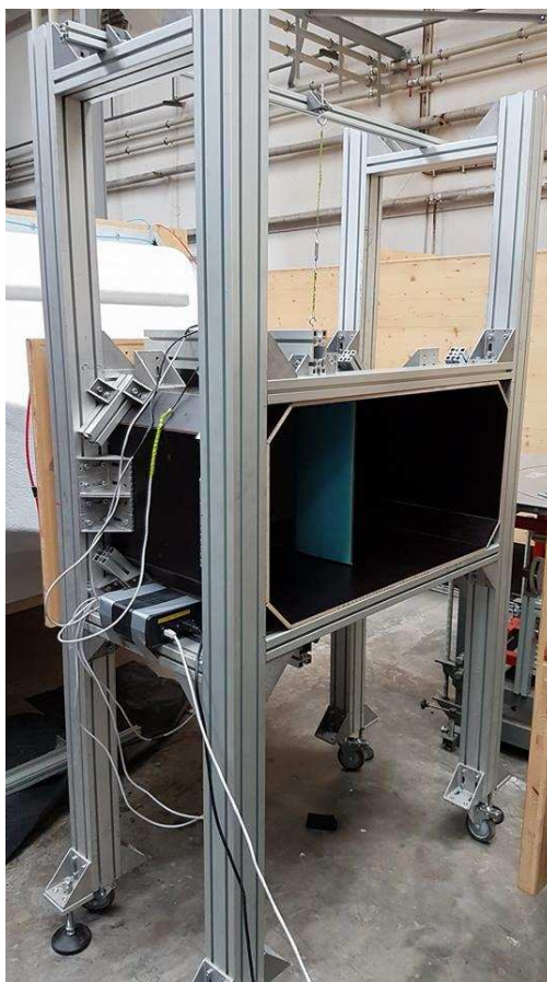
Obrázek 28: Kopletně sestavené váhy, připravené k měření
