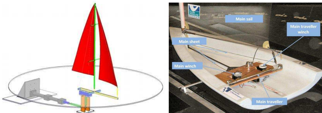
Obrázek 20: Příklad 3D vah pro vyvažování lodi (vlevo) a vah pro měření hlavní plachty i s modelem lodi s mechanismem pro ovládání plachty [18], [9]
