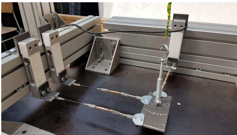
Obrázek 32: Tenzometry umístěné v rámu, připojeny k měřenému modelu a připraveny na měření
