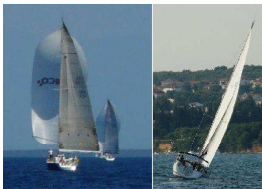
Obrázek 4: Plavba s využitím odporové (vlevo) a vztlakové (vpravo) síly
