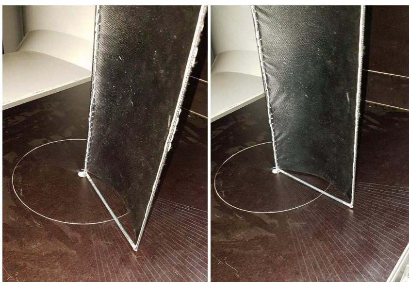
Obrázek 51: Plachta pod malým ( 4^\circ , vlevo) a velkým ( 22^\circ , vpravo) úhlem náběhu
