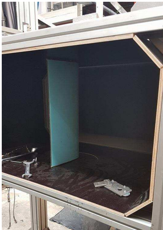
Obrázek 44: Model s profilem NACA 0012 při montáži do měřicího prostoru
