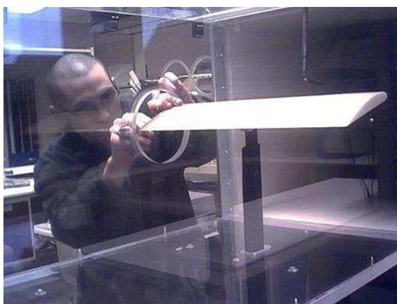
Obrázek 18: Příklad „vnitřních“ 2D vah [17]
