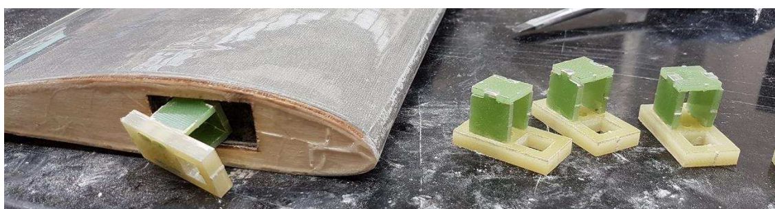
Obrázek 40: Sklotextitové bločky a jejich pozice v modelu křídla
