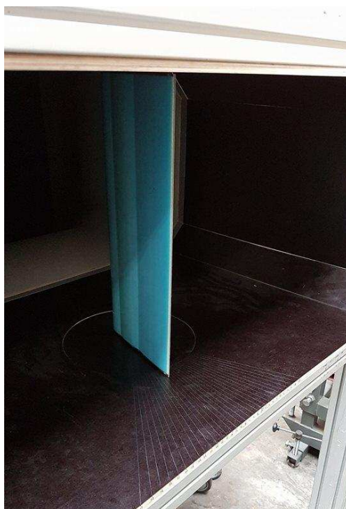
Obrázek 49: měření modelu s oboustrannou variantou profilu NACA 4415
