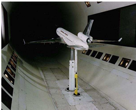
Obrázek 17: Příklad „vnitřních“ 3D vah [15]
