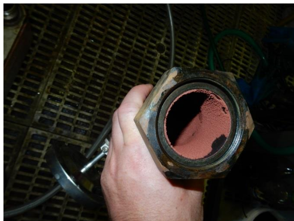
Obrázek 38 - Jemná struktura nánosů po vyčištění
