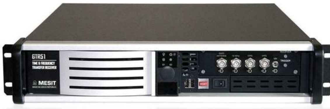
Obrázek 2.6: GNSS přijímač GTR51 [26]
