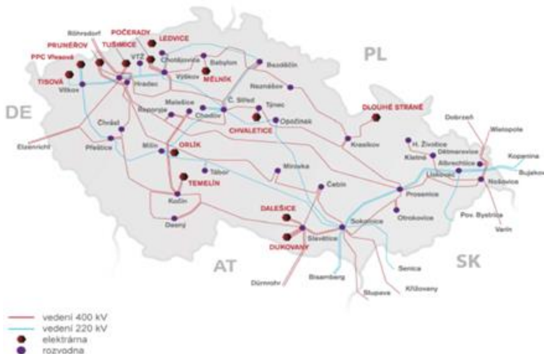
Obr. 20. Schéma rozvodné sítě v ČR [159].
