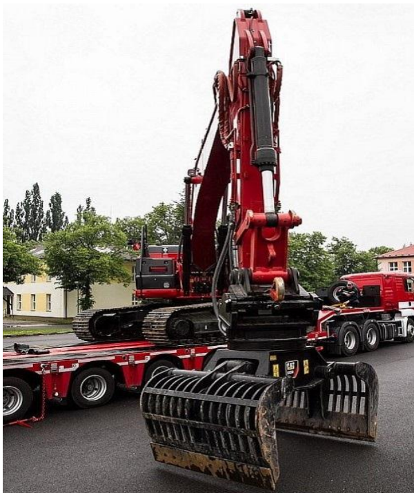
Obrázek č. 1 - Pásový bagr uzpůsobený k odklizení naplavenin zanesených koryt řek, nebo ucpaných průplavů pod mostními konstrukcemi.
