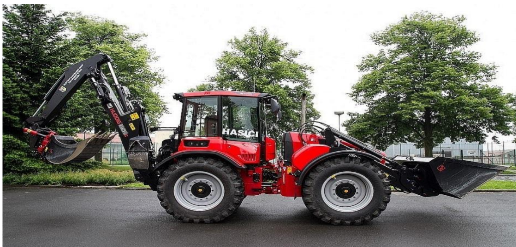
Obrázek č. 2 - Hasičský traktor-bagr s možností dálkového ovládání (pro případ zásahu v nebezpečném prostředí)
