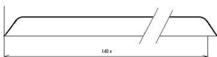
Obrázek č. 3 – Průběh signálu akustická zkouška sirén
