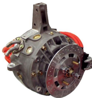
Obrázek 6 Motor umístěný v těhlici vozu Mitsubishi Colt MIEV (4)
