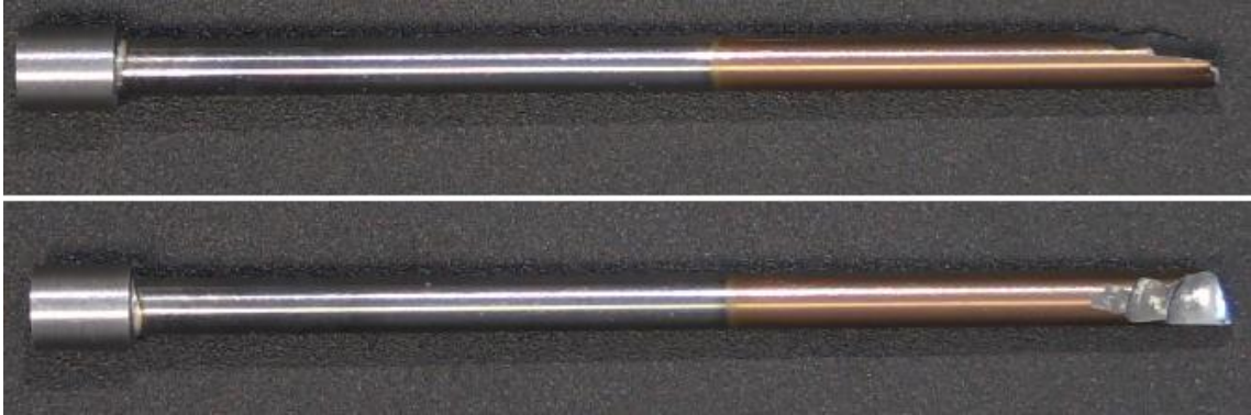
Obrázek 42 - Poškozený razník JHO TiCN
