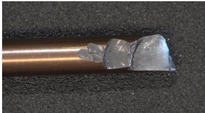
Obrázek 43 - Detail poškozeného razníku JHO TiCN
