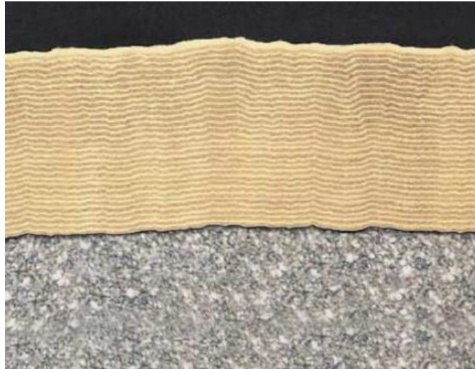
Obrázek 23 - Multivrstvý povlak TiN/TiCN – 62 vrstev o tloušťce 50nm
