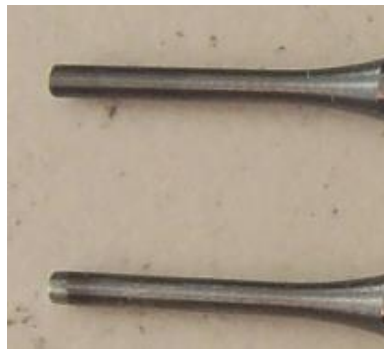
Obrázek 45 - Detail opotřebení napovlakovaného razníku Kotva
