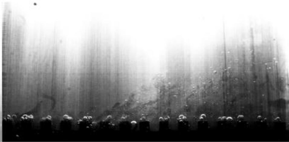
Obrázek č. 7 - vizualizace vypařování a proudění uvnitř hypervapotronu [9]
