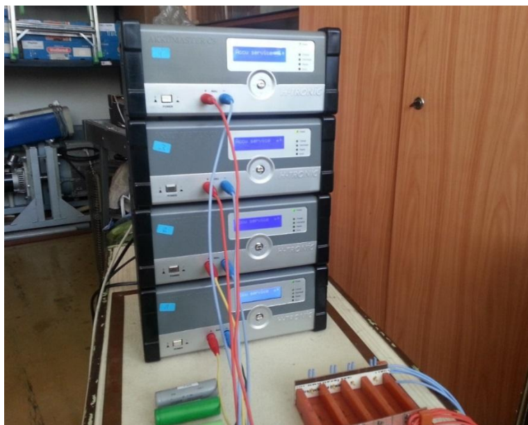
Obrázek 14: Soustava nabíjecích stanic Akkumaster C5 s nabíjecím adaptérem a měřenými vzorky v popředí
