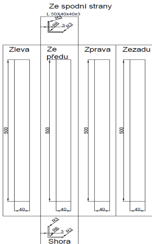
Obrázek 23: Nákres "L" profilu
