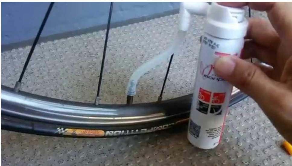
Obrázek 7: Jednoduchá oprava a plnění píchlé duše (Espresso - Effetto Mariposa, 2016)
