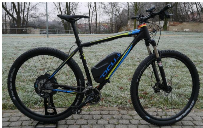
Obrázek 32 - Ukázka elektrokola s rekuperací [23]
