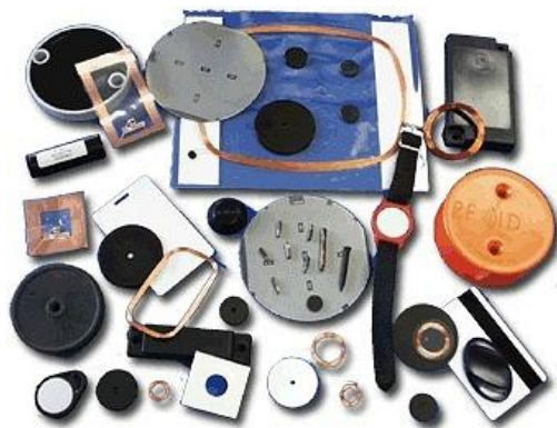
Obrázek 35 - Ukázka možných RFID čipů [30]
