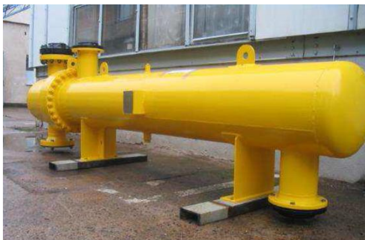
Obrázek 11: Horizontální, vodní chladič plynu, plyn v trubkách [4]
