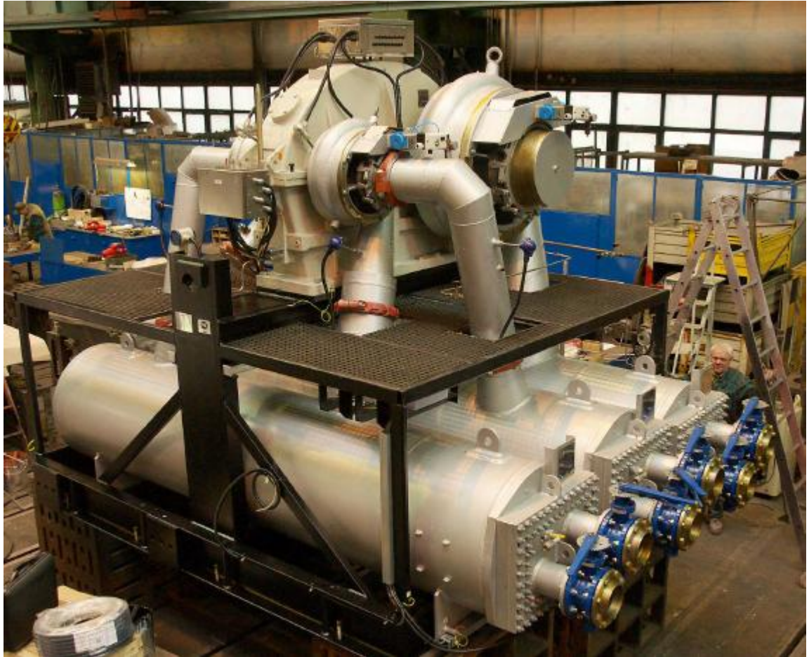
Obrázek 17: V současné době velmi často používané umístění vodních mezichladičů (v tomto případě pro převodový kompresor) [4]
