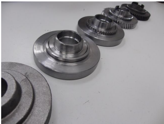
Obrázek 29: Díly 02T 311 251 N V jednotlivých stádiích výroby
