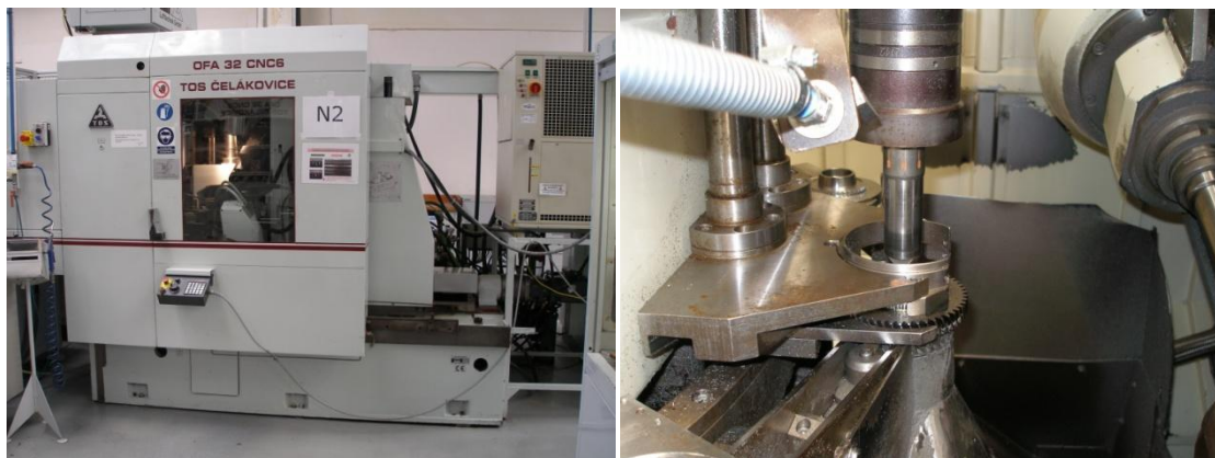
Obrázek 37: Stroj OFA 32 a upnutí během frézování ozubení [4]
