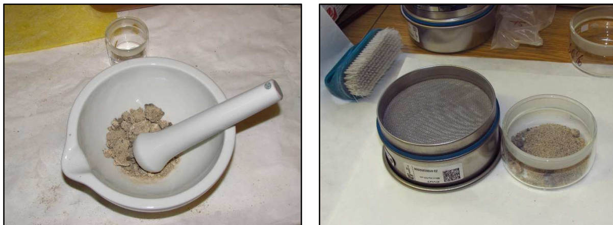
Obr. 19: Homogenizace vzorků (vlevo), příprava na vážení (vpravo)
