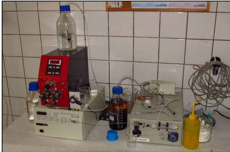
Obr. 21: Jednotlivé komponenty kapalinového chromatografu
