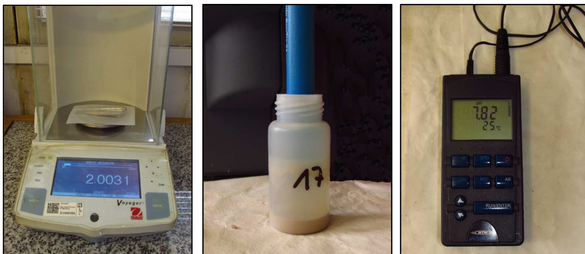
Obr. 20: Odměření navážky (vlevo), elektroda ponořená do roztoku (veprostřed), měřící modul pH/ION 740 (vpravo)
