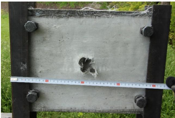
Obr. 3.16 Čelní strana se třemi vrstvami skelné tkaniny posuzované na deformovatelný projektil 7,62x39 mm
