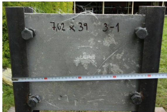
Obr. 3.17 Zadní strana se třemi vrstvami skelné tkaniny posuzované na deformovatelný projektil 7,62x39 mm
