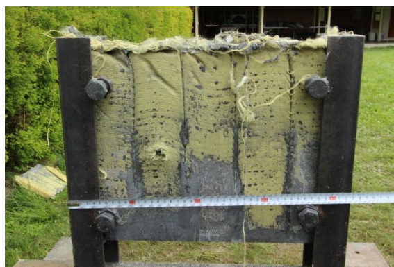
Obr. 3.20 Čelní strana s tkaninou Kevlar posuzované na deformovatelný projektil 5,56x45 mm (vlevo), nedeformovatelný projektil 5,56x45 mm (vpravo)
