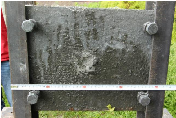
Obr. 3.14 Čelní strana s dvěma vrstvami skelné tkaniny posuzované na deformovatelný projektil 7,62x39 mm
