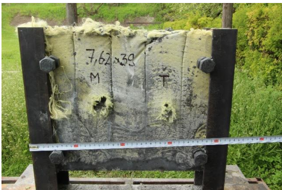
Obr. 3.18 Čelní strana s tkaninou Kevlar posuzovaná na deformovatelný projektil 7,62x39 mm (vlevo), nedeformovatelný projektil 7,62x39 mm (vpravo)
