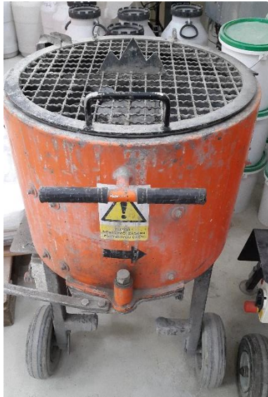
Obr. 3.3 Talířová míchačka o objemu 40 l
