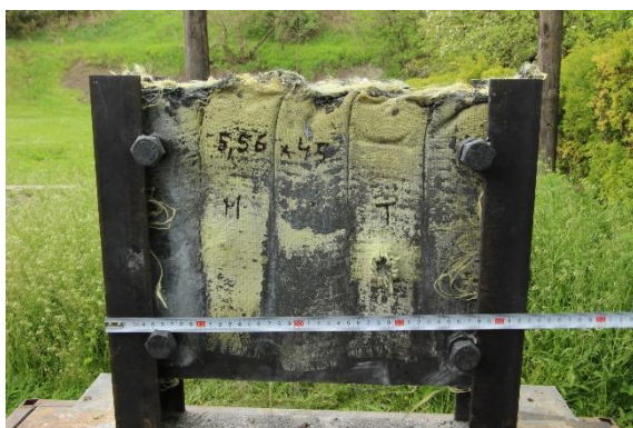
Obr. 3.21 Zadní strana s tkaninou Kevlar posuzované na deformovatelný projektil 5,56x45 mm (vpravo), nedeformovatelný projektil 5,56x45 mm (vlevo)
