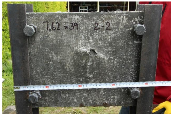
Obr. 3.15 Zadní strana s dvěma vrstvami skelné tkaniny posuzované na deformovatelný projektil 7,62x39 mm
