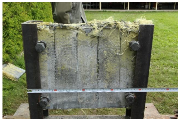
Obr. 3.19 Zadní strana s tkaninou Kevlar posuzovaná na deformovatelný projektil 7,62x39 mm (vpravo), nedeformovatelný projektil 7,62x39 mm (vlevo)
