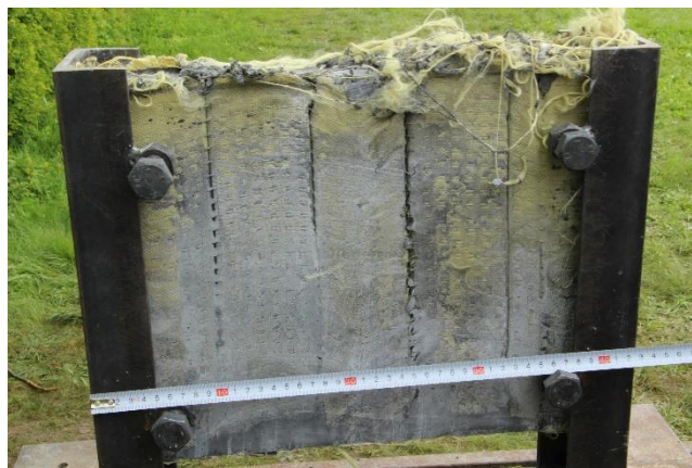
Obr. 3 9 Vybetonovaná deska směsi UHPFRC s tkaninou Kevlar
