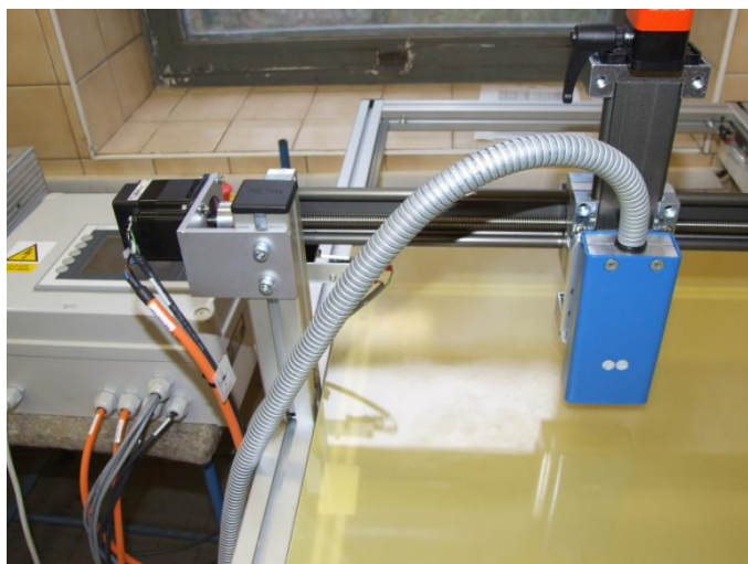
Obr. 13 Tryska pro plazmovou úpravu [10]
