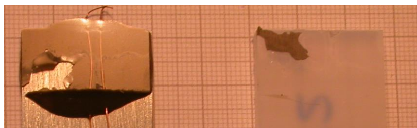
Obr. 22 Vzorky po plazmování s vymezením tloušťky spoje drátky po zkoušce tahem, lepidlo DP190
