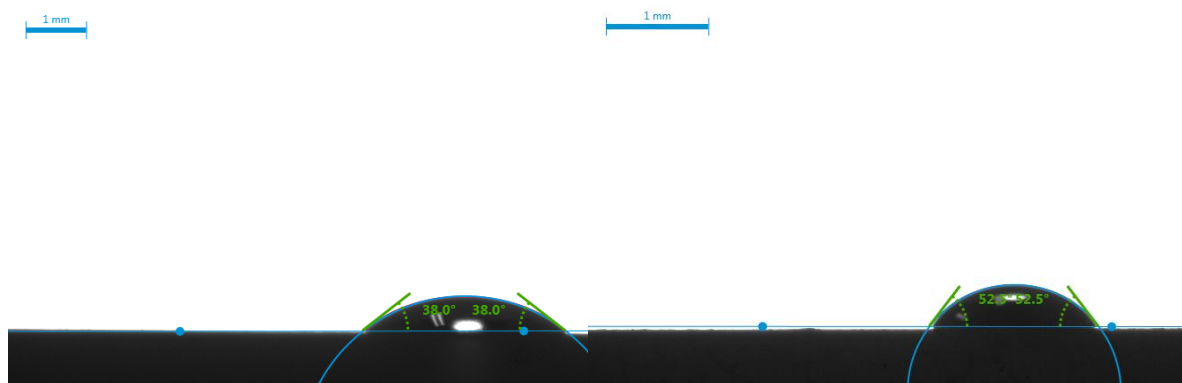
Obr. 26 Porovnání velikostí kontaktních úhlů na vzorcích PP, vlevo P50, vpravo ZS, kapalina diiodo-methane
