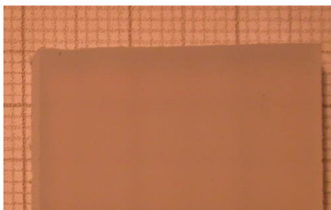
Obr. 19 Vzorky z PP ZS po zkoušce tahem, lepidlo DP190
