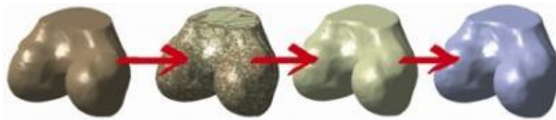
Obrázek 14: Model kloubu-plochy STL-uzavřený plošný-objemový model [13]
