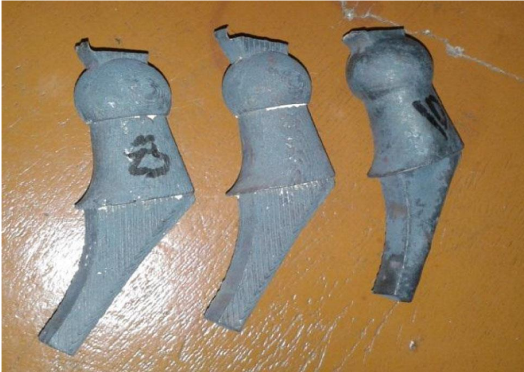
Obrázek 11: Odlitek kyčelního kloubu (hip joint) [11]
