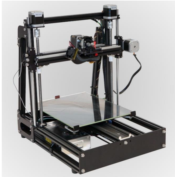
Obrázek 17 Ukázka možnosti pojezdu plošiny ( http://josefprusa.cz/mendelmax2.jpg )
