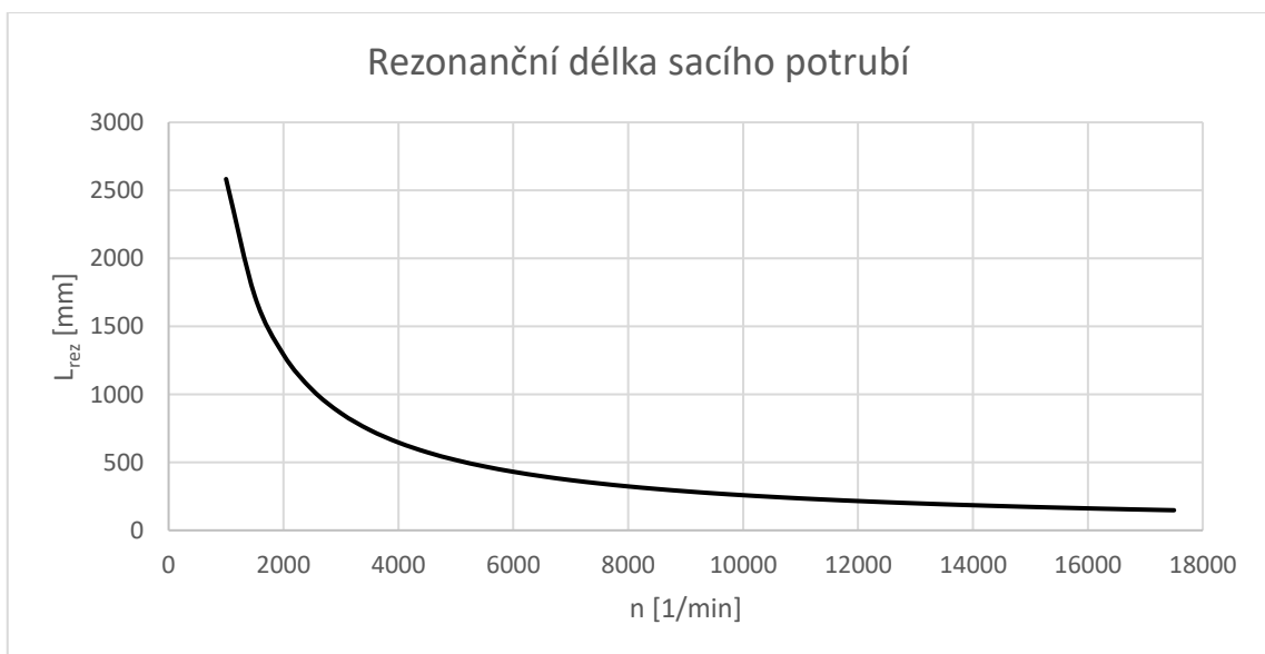
Obr. 8 - Rezonanční délka potrubí
