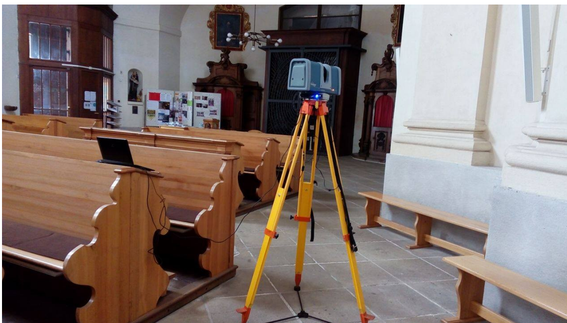
Obr. 8 Surphaser 25HSX při práci v kostele
