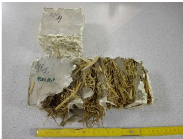
Obr. 34: Vzorky z Ekopanelu – vzorek A 12 po kontaktu s kapalnou vodou
