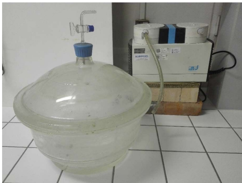
Obr. 17: Exsikátor pro měření vakuové nasákavosti
