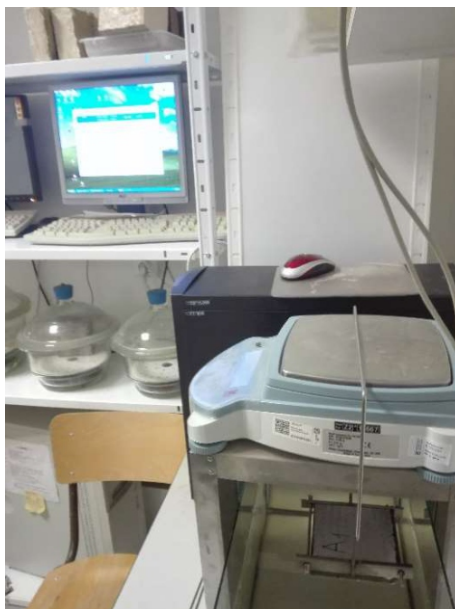
Obr. 20: Metoda vertikální nasákavosti – automatické vážení kalcia-silikátu
