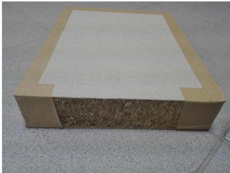
Obr. 13: Tepelná izolace Ekopanel z lisované slámy
