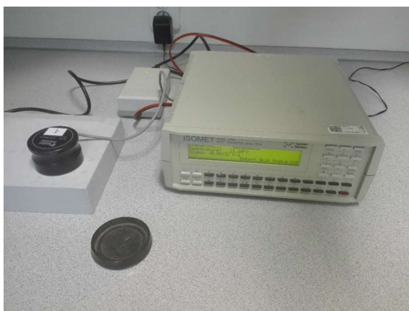
Měření tepelných parametrů kalcia-silikátu pomocí přístroje ISOMET 2104
