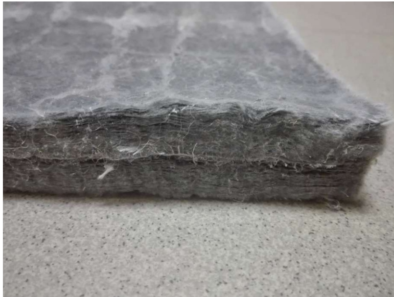
Obr. 12: Izolační rohože na bázi aerogelu vyztužené textilními vlákny
