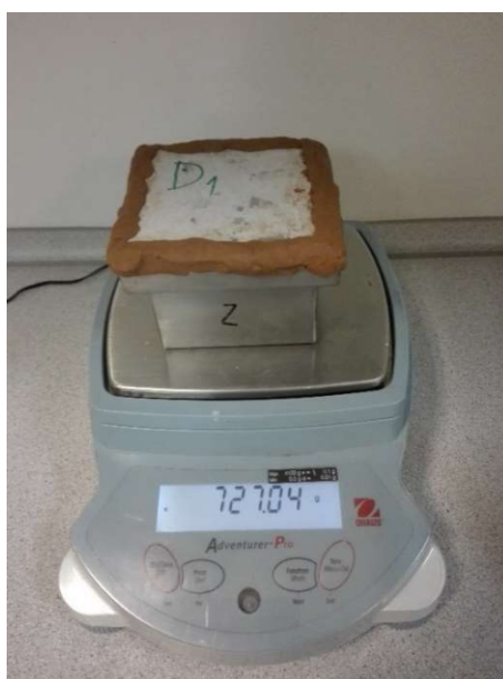
Obr. 18: Misková metoda – vážení vzorku kalcia-silikátu
