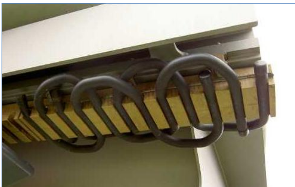
Obr. 6 Transrapid – třífázové statorové vinutí [8]
