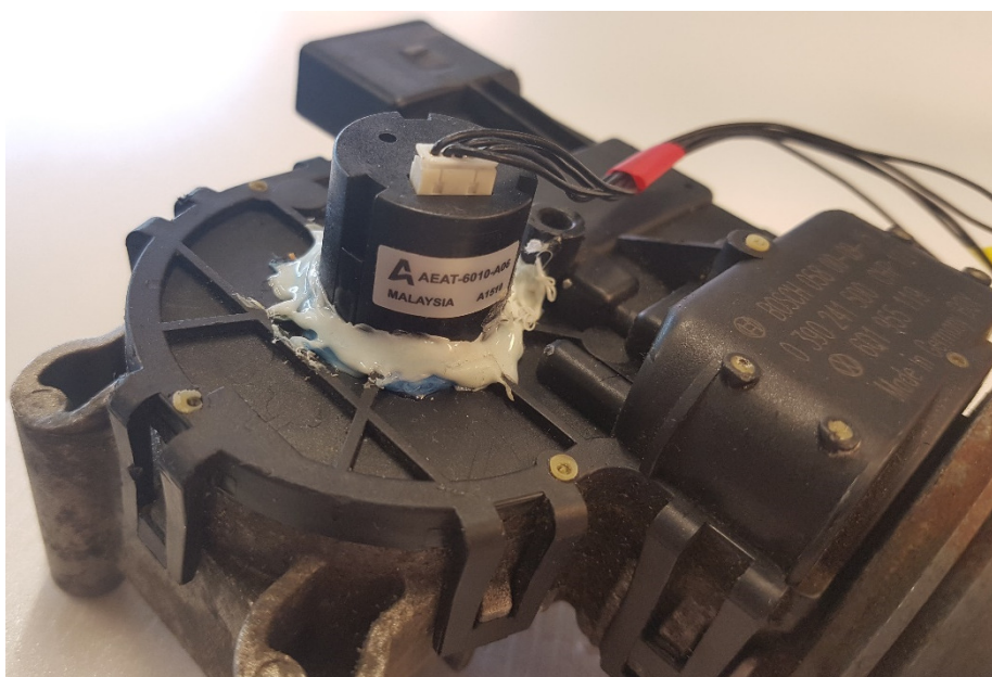
Obrázek 14) Detail připevnění enkodéru k motoru
