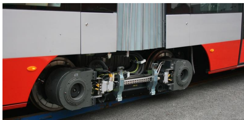
Obrázek 14: hnací podvozek Škody 15T s trakčními motory na vnější straně portálové nápravy [10]
