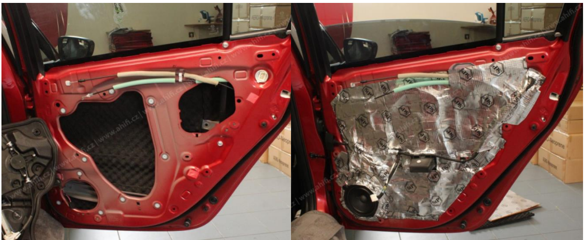
Obr. 18: Odhlučnění vnějšího a vnitřního plechu dveří u Mazdy 6 [22]
