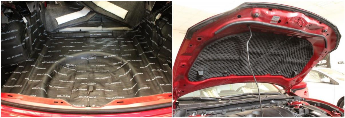
Obr. 17: Odhlučnění zavazadlového prostoru a kapoty motoru u Mazdy 6 [22]
