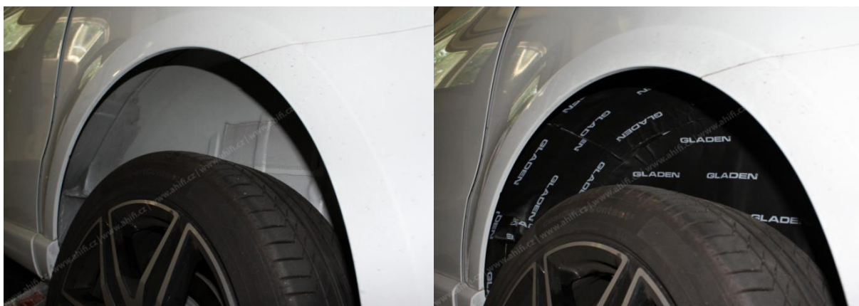
Obr. 19: Ukázka aplikace tlumícího materiálu v podběhu vozidla Mercedes-Benz Vito, vlevo před aplikací, vpravo po aplikaci [23]
