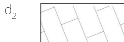
d 2 dlažba - betonová výrobce_BEST název_Belisima rozměr_600x 300mm materiál_beton
