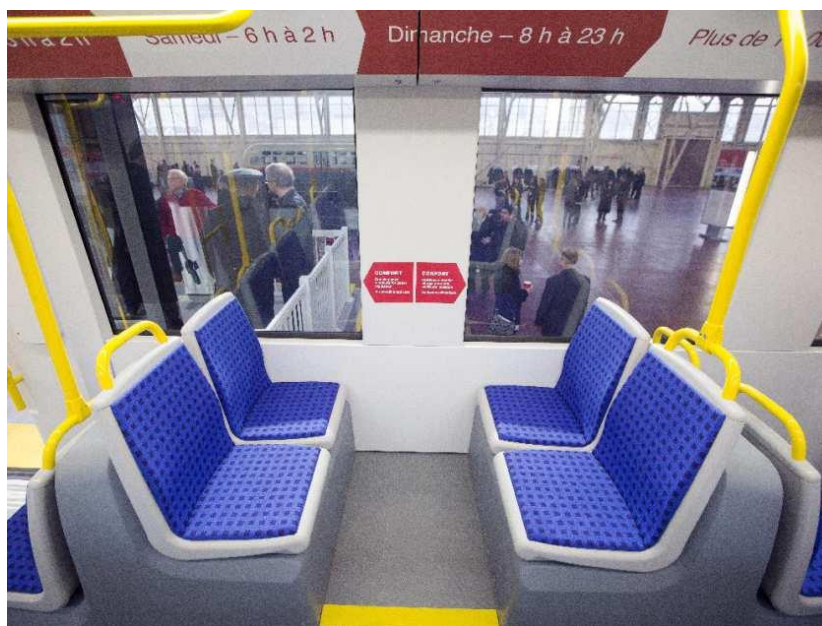
Obr. 15.: Interiér nad podvozky vozidla Alstom Citadis Spirit Ottawa [16]
