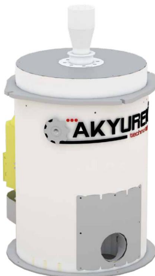
Obr. 20. Loupačka firmy Akyurek, typ ID-900
