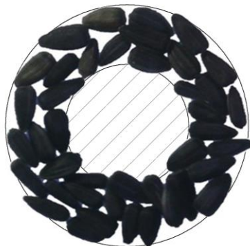
Obr. 31. Distribuce semen v průřezu šneku
