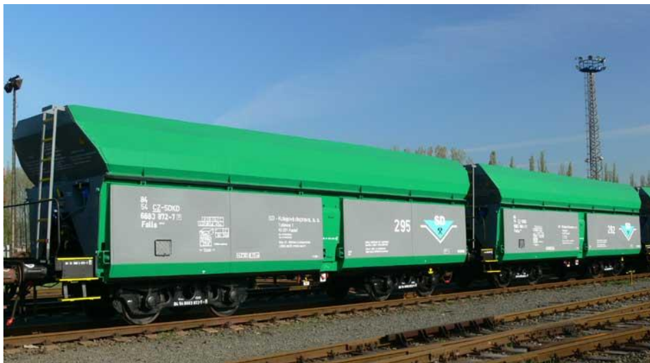
obr. 15.: Samovýšpný vagón Falls 84 54 6683 872-7 SD-kolejová doprava, a.s. (převzato z [19])
