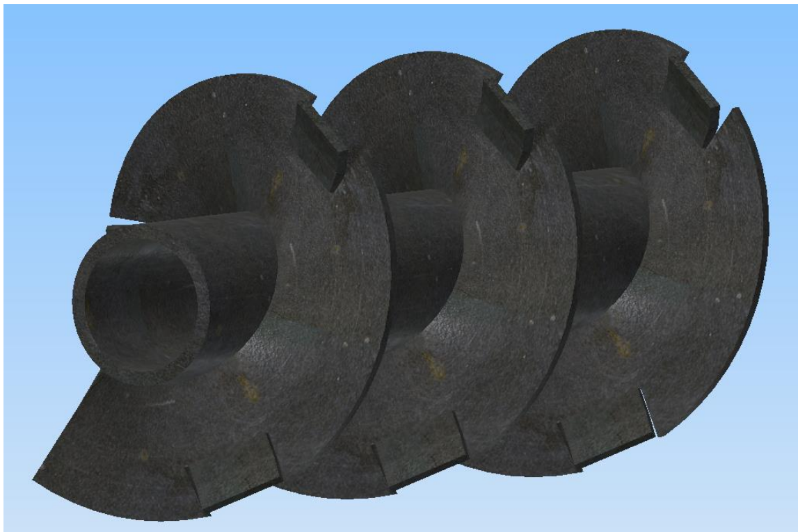
obr. 20.: 3D model části šnekovnice s vyhnutými lopatkami (řešení D)
