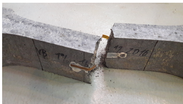
Obrázek 3.5: Ukázka tahového poškození
