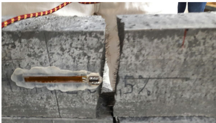
Obrázek 3.8: Tahová trhlina s přibližně rovinným průřezem. K rozvoji trhliny došlo v předpokládané části prvku, a to v oblasti zúžení
