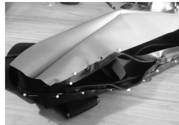
Vrchní část kapsy z finálního materiálu (plachtoviny)
