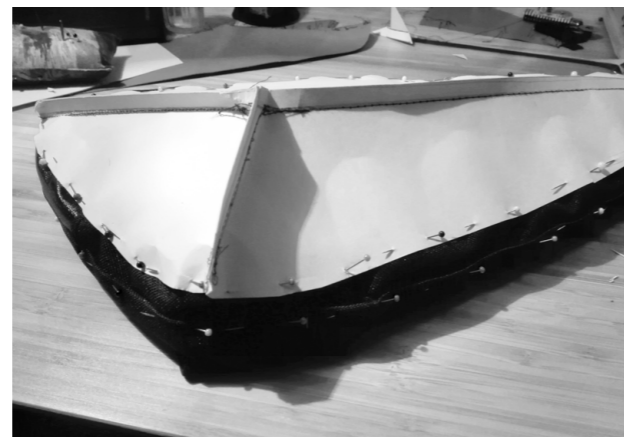
Papírový model vrchní části kapsy přichycený k zadní části + korekce obvodu
