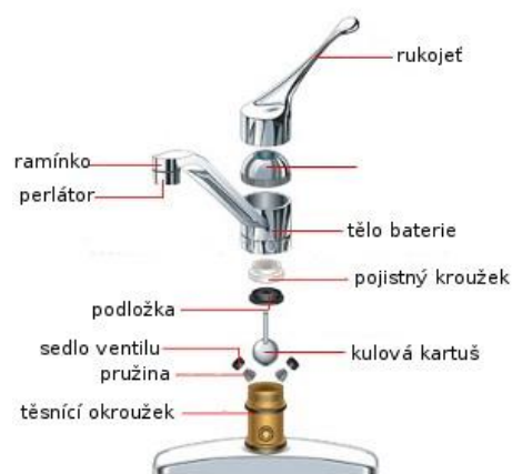
Obr. 34: Páková vodovodní baterie s kulovou kartuší (15)
