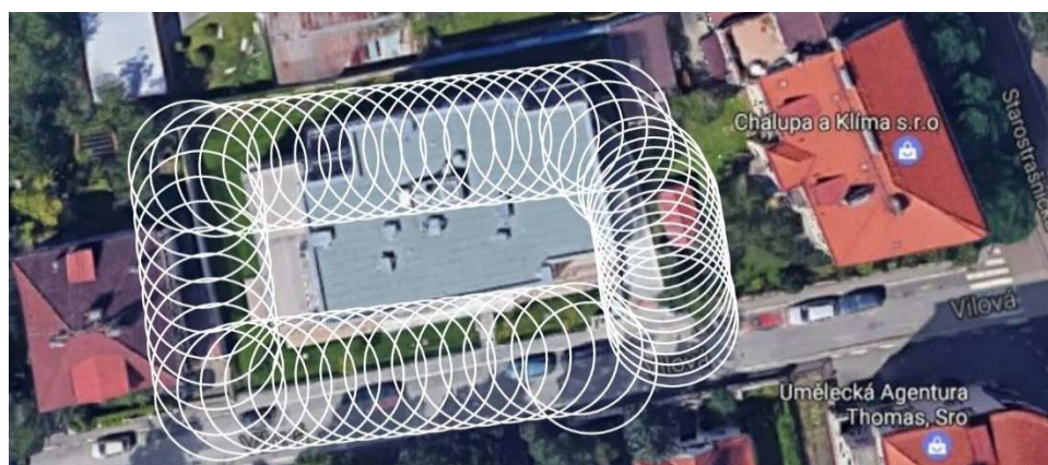
Obr. 12 – Vyznačení nebezpečného prostoru vrtné soupravy (9)
