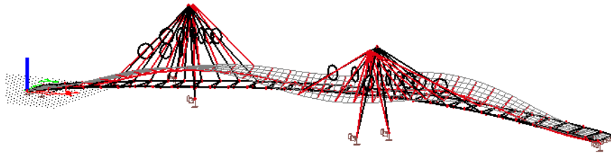
Obrázek 42 - Deformovaná konstrukce při vlastní frekvenci 2,03 Hz – torzní tvar
