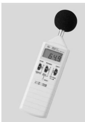
Obr. 15: Použitý hlukoměr BEHA 93411 [11]
