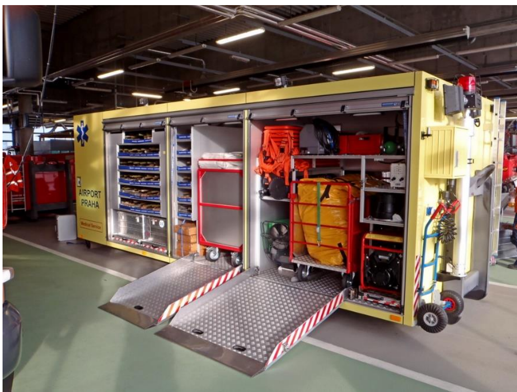
Obr. 5 - Zařízení pro izolaci nakažených cestujících [8]
