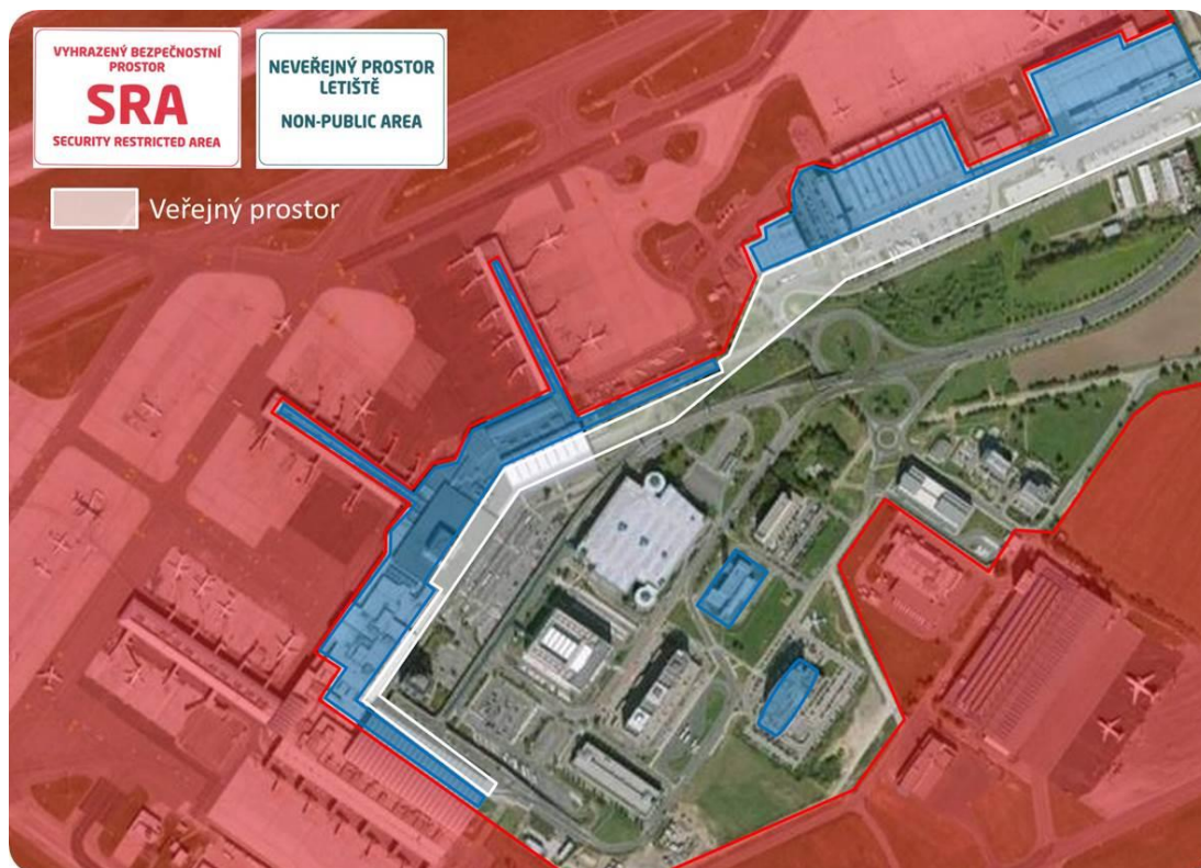
Obr. 1 - Rozdělení severní části areálu letiště na bezpečnostní zóny [9]
