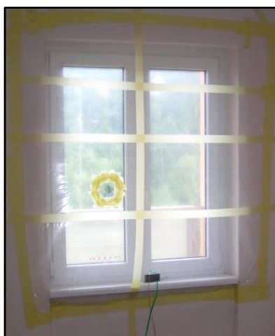
Obr. č.12: Pohled na měřené okno s nalepenou fólií a osazenou clonou 1,5 cm
