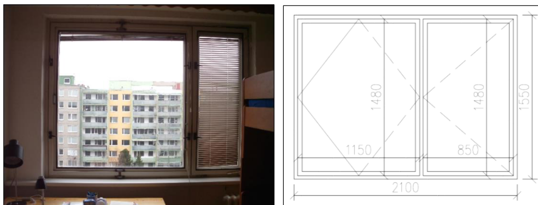
Obr. č.8: Pohled na měřené okno (vlevo) a schéma s rozměry (vpravo)
