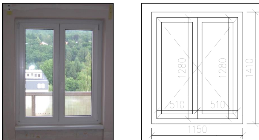
Obr. č.11: Pohled na měřené okno (vlevo) a schéma s rozměry (vpravo)
