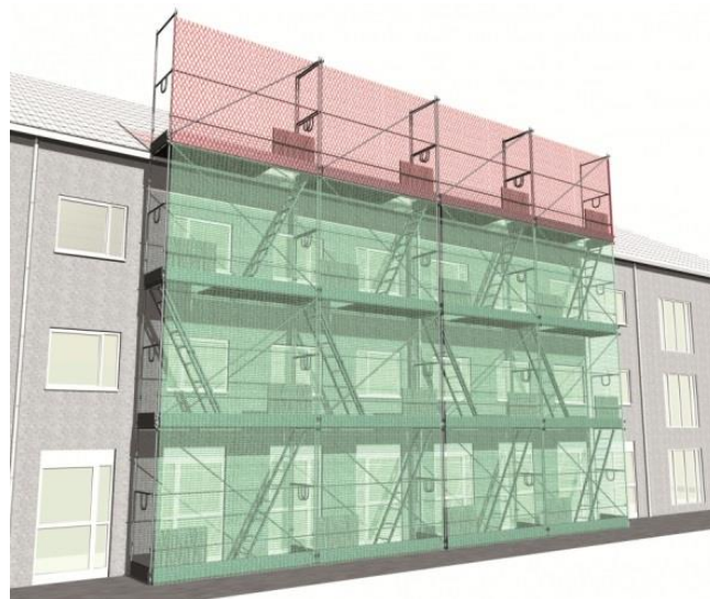
Obr. 18: Bezpečnostní síť typu U [17]
